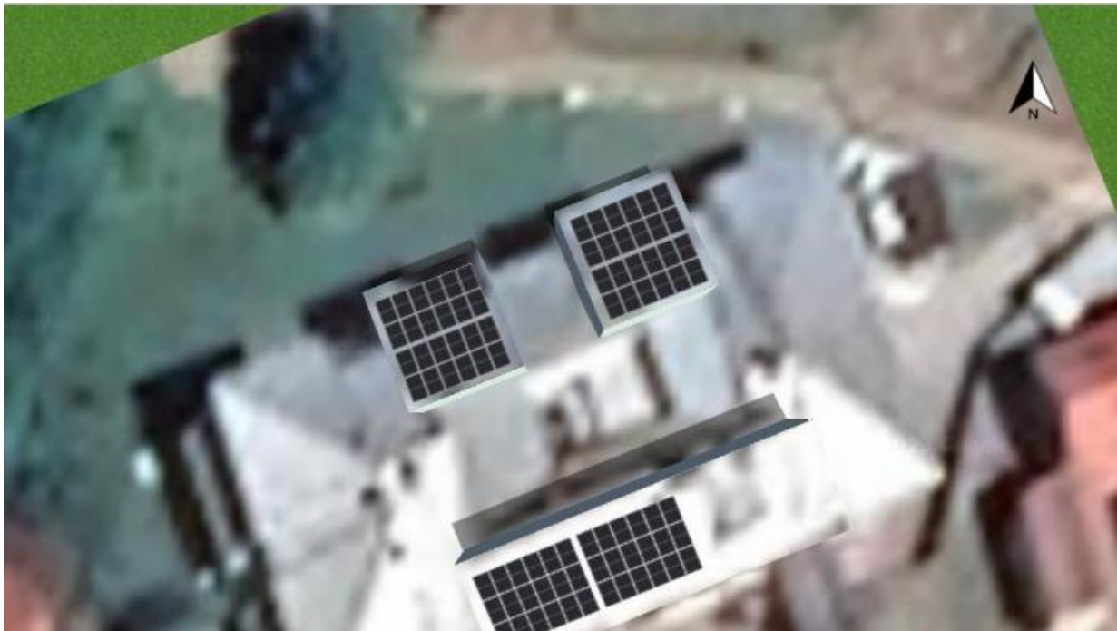
Слика 2. Визуелен приказ на предвидениот фотоволтаичен систем на кровните површини на ОЈУДГ Детелинка - Пролетна Роса - Крива Паланка
