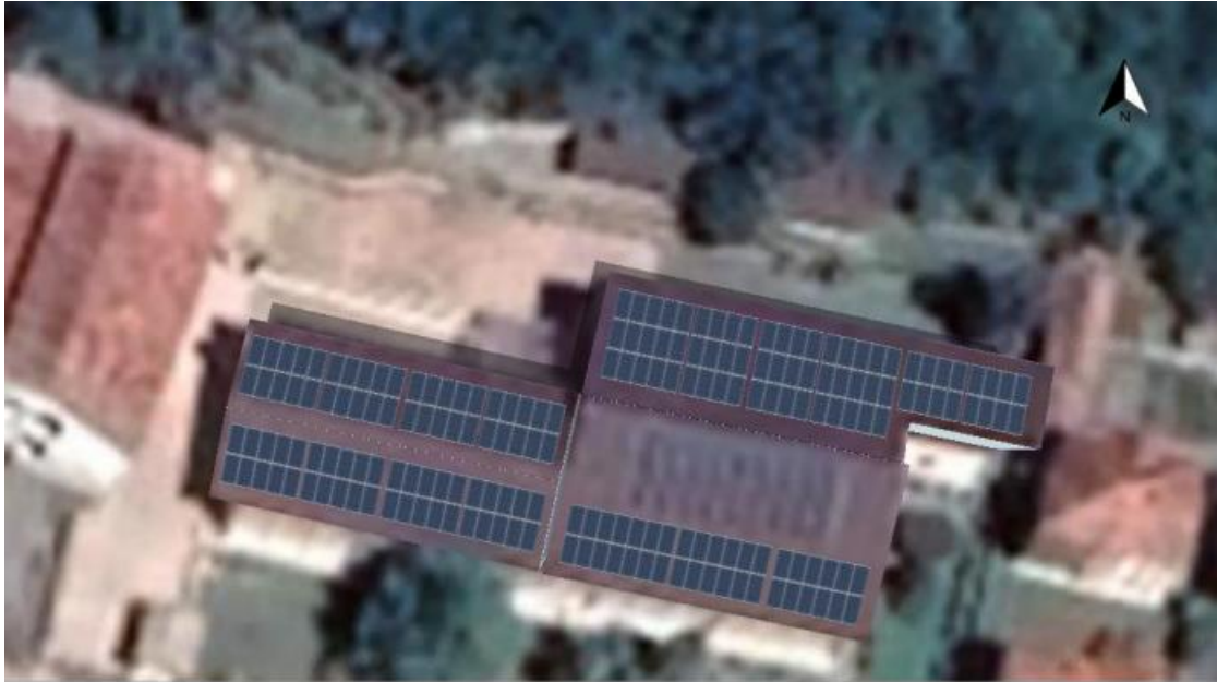
Слика 7 Визуелен приказ на предвидениот фотоволтаичен систем на кровните површини на СОУ Горче Петров - Крива Паланка
