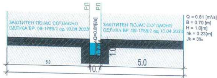
УСВОЕН НАПРЕЧЕН ПРЕСЕК НА КОРИТО НА „ДОЛ ЖИТЕН СКЛАД“ - ПРАВОАГОЛЕН ПРОФИЛ - согласно „Хидролошка студија за регулација на водотеци за Генерален урбанистички план во Крива Паланка, општина Крива Паланка“ - 2022год. M=1:100
