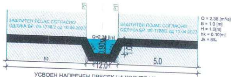
УСВОЕН НАПРЕЧЕН ПРЕСЕК НА КОРИТО НА „ДОЛ ГРАМАГЕ 4“ - ТРАПЕЗЕН ПРОФИЛ - согласно „Хидролошка студија за регулација на водотеци за Генерален урбанистички план во Крива Паланка, општина Крива Паланка“ - 2022год. M=1:100
